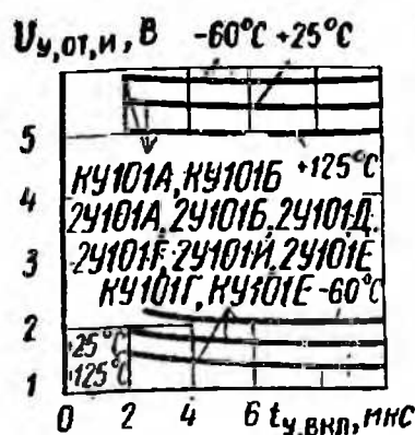
Зависимости отпирающего импульсного напряжения управления от времени включения
