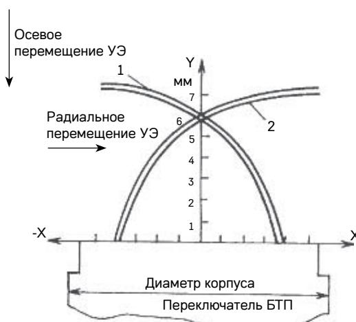
Рабочая зона воздействия управляющего элемента на срабатывание выключателя:
